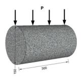
Figure 2. Model benda uji pengujian kuat tarik
